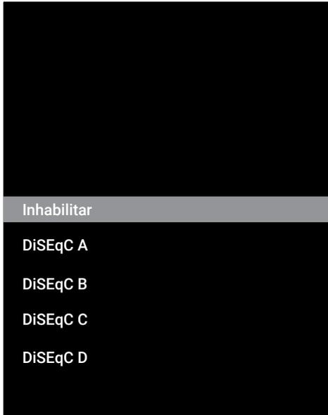
19. Para seleccionar el satélite correspondiente a las posiciones DiSEqC relevantes en el sistema de satélites, seleccione **DiSEqC A**, **DiSEqC B**, **DiSEqC C** y **DiSEqC D**.
