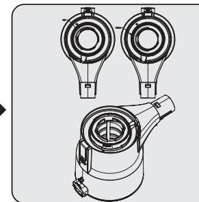
При установке металлического фильтра и поролонового фильтра на входе в пылесборник, от которого вы их отсоединили, поместите их в соответствии с символами замка на пылесборнике.
