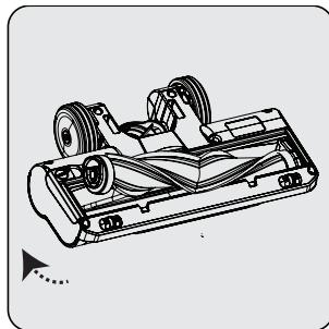
После очистки роликовой щетки повторно установите ее и заблокируйте фиксатор.
