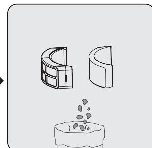
Удалите пыль с фильтра EPA E10 и поролонового фильтра на выходе, постучав ими о твердую поверхность, например, мусорный бак, или используя щетку.
