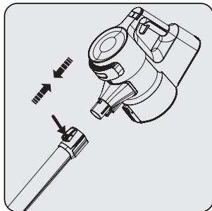
Установите трубу на конец корпуса (8). Снимайте ее, нажав кнопку разблокировки.
