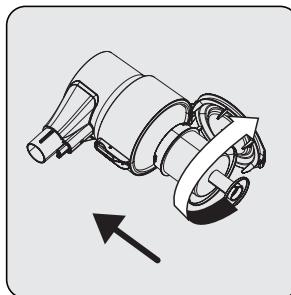
Установите металлический фильтр в пылесборник (9), повернув его по часовой стрелке.
