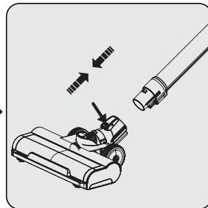
Нажмите кнопку разблокировки и электрической турбощетки (5) на электрической турбощетке (6) и нажмите ее в направлении стрелки к трубе.
