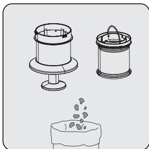
Удалите пыль с металлического и поролонового фильтра на входе, постучав ими о твердую поверхность, например, мусорный бак, или используя щетку.
