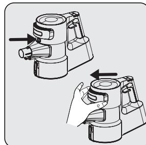
Снимите крышку, одновременно нажимая кнопку разблокировки фильтра EPA E10.
