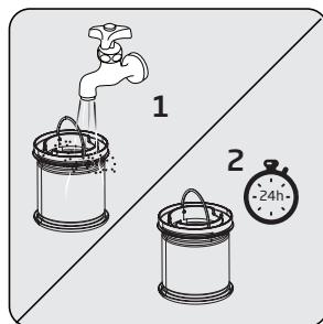
Промойте поролоновый фильтр на входе под струей холодной воды и дайте высохнуть.
