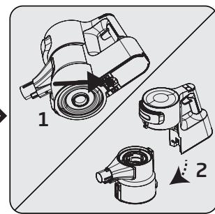
Нажмите спусковой крючок под прибором, чтобы очистить пылесборник (9). Отсоедините пылесборник (9) от корпуса (8).
