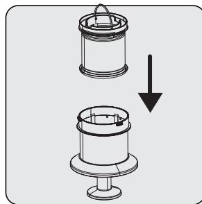
Установите сухой поролоновый фильтр на входе на металлический фильтр.
