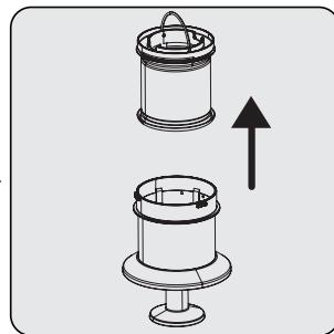
Снимите входной поролоновый внутри металлического фильтра.
