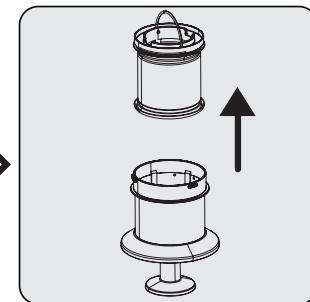
Снимите входной поролоновый фильтр внутри металлического фильтра.
