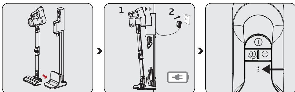
Закрепите колеса электрической турбощетки (6) в зазоре на опоре зарядного устройства (14).
