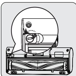
Чтобы снять электрическую турбощетку (6), откройте защелку с помощью фиксатора роликовой щетки в направлении стрелки. (Можете использовать монету)
