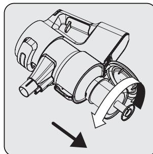
Снимите металлический фильтр и поролоновый фильтр на входе внутри пылесборника (9), повернув металлический фильтр против часовой стрелки.
