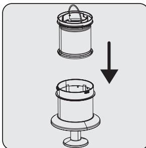
Установите поролоновый фильтр на входе на металлический фильтр.
