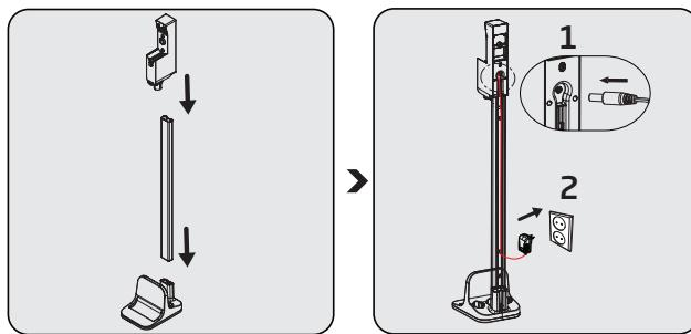
Установите трубку зарядной док-станции (13) на опору зарядной док-станции (14), затем установите зарядную док-станцию (12) на трубку зарядной док-станции (13).
