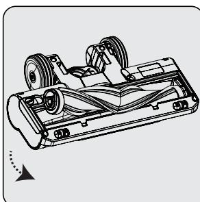
Снимите роликовую щетку.
