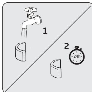
Регулярно проверяйте поролоновый фильтр на выходе. Очищайте его, промывая под проточной холодной водой и предварительно удаляя пыль в случае чрезмерного запыления. Повторно установите его, когда он высохнет.
