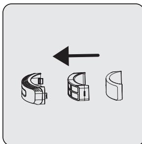
Установите фильтр EPA E10 и поролоновый фильтр на выходе на крышку.
