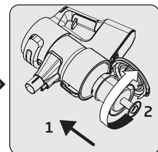
Снимите металлический фильтр и поролоновый фильтр на входе внутри пылесборника (9), повернув металлический фильтр против часовой стрелки.
