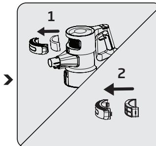
Снимите фильтр EPA E10 и поролоновый фильтр на выходе внутри него.
