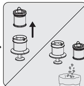
Снимите входной поролоновый внутри металлического фильтра.
