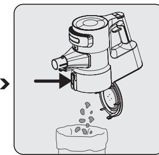
Нажмите кнопку открытия крышки резервуара для пыли (10), чтобы открыть пылесборник (9) и извлечь пыль, собранную внутри.
