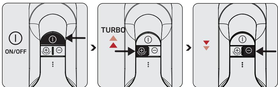
Нажмите кнопку включения / выключения (1), чтобы включить прибор. При нажатии кнопки включения / выключения прибор начинает работать с минимальной скоростью.
