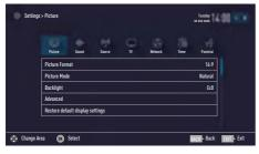
4 Select the required line »Picture Format«, »Picture Mode« or »Backlight« with »√« or »∧« and press »OK« to confirm. Select the option with »≪« or »>«. Press »BACK ← « to return to »Picture« menu.
