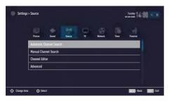
4 Select the line »Automatic Channel Search« with »V« or »∧« and press »OK« to confirm.
