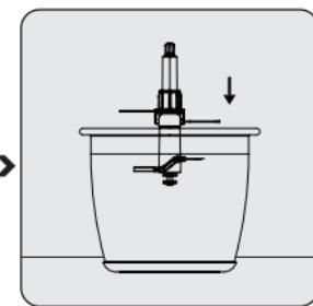
Oštricu sjeckalice (6) stavite na fiksnu osovinu (2) drci oštricu za plastični dio.
