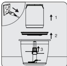
Выключите изделие из розетки. Снимите блок двигателя (4) и распорную крышку (3), а затем – лезвия (6).
