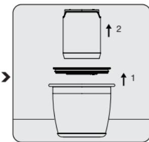
Uklonite jedinicu motora (4) i poklopac (3) sa staklene zdjele (1).
