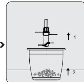
Wenn der Vorgang abgeschlossen ist, hören Sie auf, die Bedientaste zu drücken. Trennen Sie das Gerät vom Netz und warten Sie, bis das Messer vollständig zum Stillstand gekommen ist.
