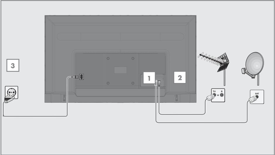
**1** Für den Empfang von digitalen Satellitensendern (DVB-S) stecken Sie das Satellitenantennenkabel in die Antennenbuchse »**SATELLIT**« am Fernsehgerät;
